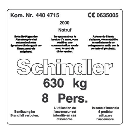
La placa de identificación puede cambiar en función del tipo de ascensor y de la normativa local. Esta placa contiene información importante acerca de la instalación del ascensor, como el año de activación, el número de pedido, indicación de peso, número de personas, etc.
